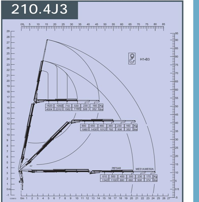
**I** Versione std.: Ce idraulico\_Limitatore di momento\_Commandi bilaterali in basso\_Rotazione con cilindri e cremagliera\_Bracci esagonali\_Doppie bielle\_Cilindri di filo indipendenti\_Piedi orientabili a estrazione idraulica\_Norme DIN 15018 H1B3
