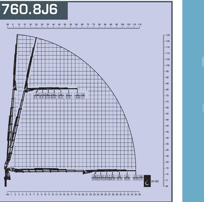
I Versione std. - CE: impianto di sicurezza elettronico CSS - distributore proporzionale su colonna - radiocomando Hetricnic - scambiatore di calore - limitatore di momento - 1 motoriduttore di rotazione sulla (2° motoriduttore opzionale) - Bracci esagonali - Doppie biele - Cilindri di sfilo indipendenti con dispositivo HSE - Piedi orientabili a 90 ° a estensione idraulica 8,8 m. - Norme DIN 15018 H1B3 - **HSE** System
